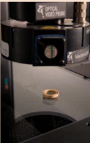
Controllo dimensionale su un E-Cup seals
